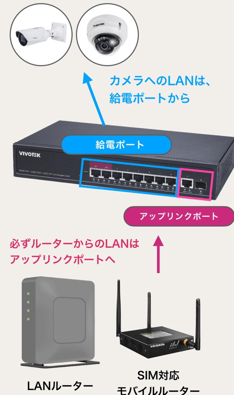
PoEスイッチングハブには、ルーターからのLANケーブルを挿入するアップリンクポートと、カメラにケーブルを挿入する給電ポートで成り立ちます。この方法以外の接続をすると通信不能となります。
